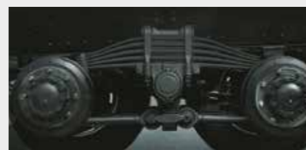
Подвеска на полуэллиптических рессорах
